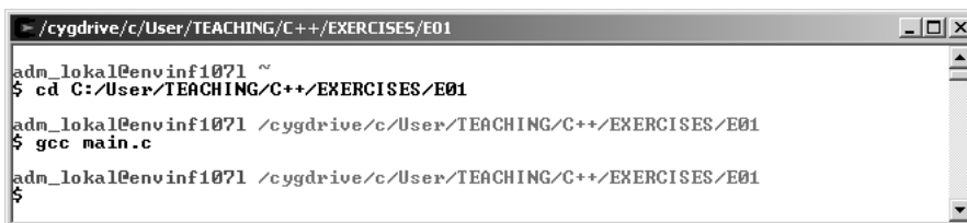
Abbildung 1.10: Kommandozeile: gcc main.c, das Ergebnis ist a.exe, Aufruf des Programms: ./a
