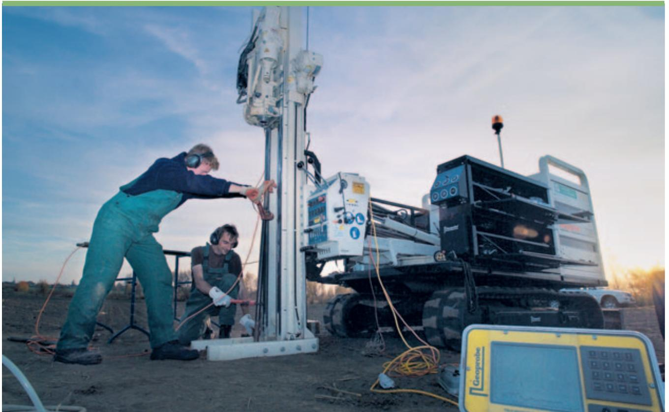
„Direct push“-Bohrgerät im Einsatz. Es ermöglicht, den Untergrund schnell, effektiv und hoch aufgelöst zu erkunden, Proben zu nehmen, online zu untersuchen und damit Schadstoffquellen zu lokalisieren oder Grundwassermessstellen und Monitoringsysteme zu installieren. Das Besondere: Im Gegensatz zu herkömmlichen Bohrgeräten, bei denen mit Bohrschnecken der Untergrund erschlossen wird, arbeiten diese Systeme mit einem Hohlgestänge, das in den Untergrund gedrückt wird (direct push).
