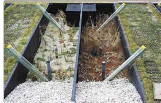
Kurz nach der Bepflanzung der Horizontalbeete von Langenreichenbach erlauben Spezialkameras auch einen Blick unter die Oberfläche in den Wurzelbereich hinein. Zur Aufnahme werden die Kameras in die schräg aufragenden Rohre eingeschoben. (Quelle: Dr. Oliver Bederski, UFZ)
