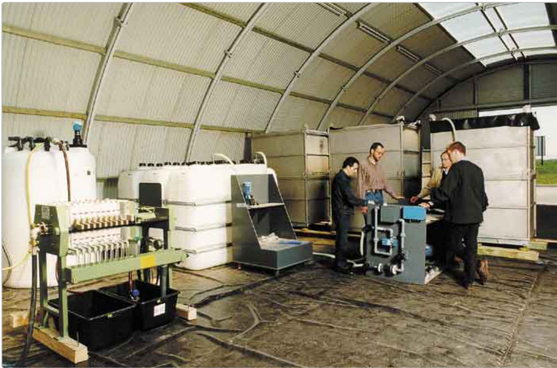
Bild 8: BIOLEA-Pilotanlage in Hirschfeld zum Bioleaching von vererdeten Sedimenten (Quelle: Norma Neuheiser, UFZ)
