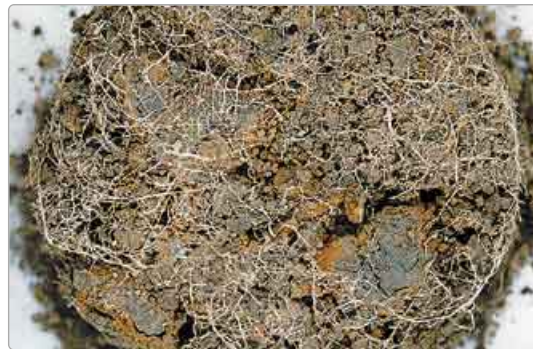
Bild 4: Durchdringung eines gebaggerten Sedimentes mit Pflanzenwurzeln
