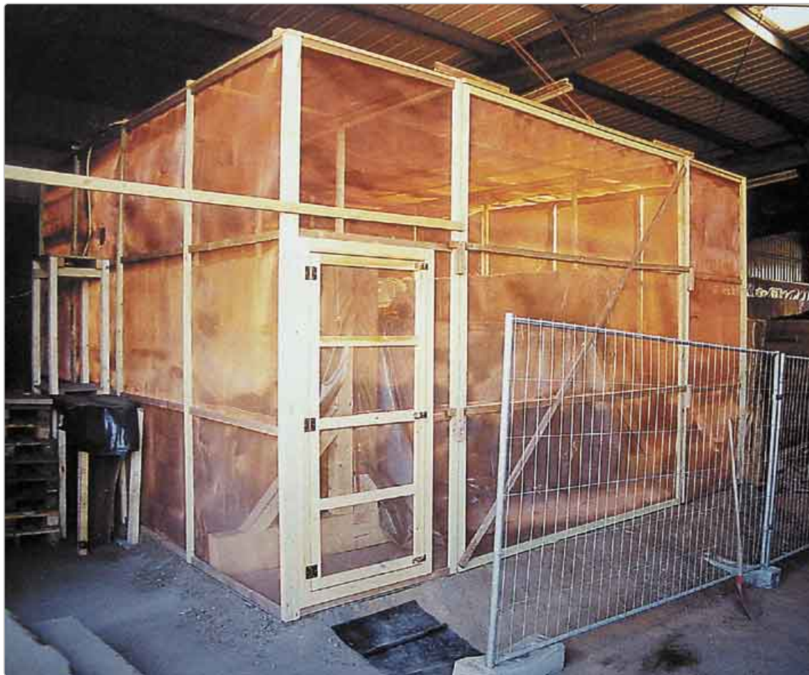
Bild 3: Der Reaktor zur Radiowellenerwärmung in der Halle des Bodenreinigungszentrums Hirschfeld (Quelle: UFZ, Sektion Sanierungsforschung)
