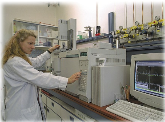
Bild 4: Analyse der Grundwasserproben mit gaschromatografischer Trennung und massenselektiver Detektion (Foto: Norma Neuheiser, UFZ)
