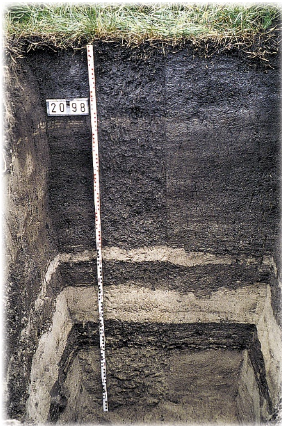
Bild 4: Ein Bodenprofil in der Elbaue bei Wörlitz. Der Wechsel von tonigen und sandigen Substraten infolge mehrmals pro Jahr auftretender Hochwässer ist gut zu erkennen. (Foto: Jörg Rinklebe, UFZ)
