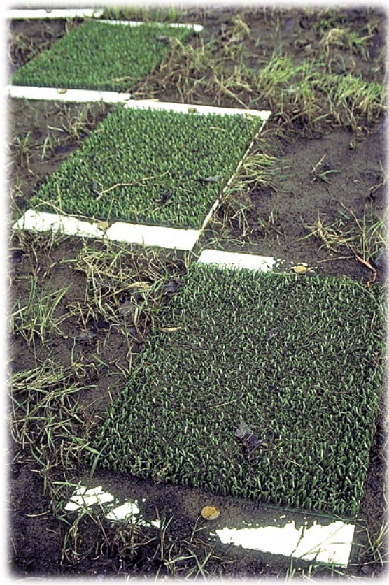
Bild 7: Sedimentfallen zur Messung von sedimentiertem Material (Schwebstoff) in der Nähe des Elbufers (Foto: Frank Krüger, UFZ)
