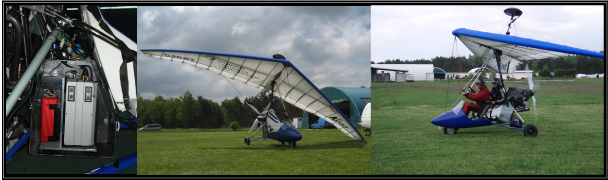
Abbildung 3: Eingebauter Hyperspektralsensor AISA-EAGLE (400-970nm) sowie GPS/INS im Ultraleichtflugzeug (Trike) des UFZ
