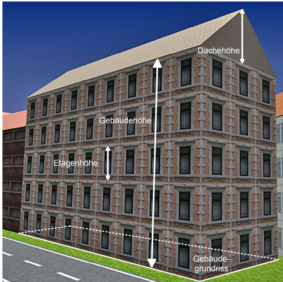
Abbildung 1.2: Aus einem Grundriss und einigen Parametern prozedural erzeugtes Gebäudemodell
