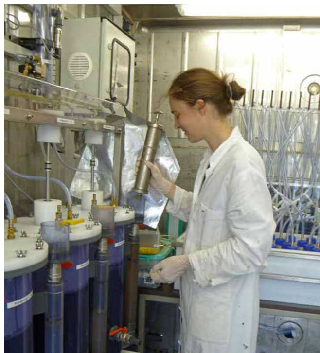
Abb. 37: Durchlaufreaktor für anaerobe Klärschlamm-Stabilisierungsversuche. → Foto: H. Feldhaus, TU Braunschweig
