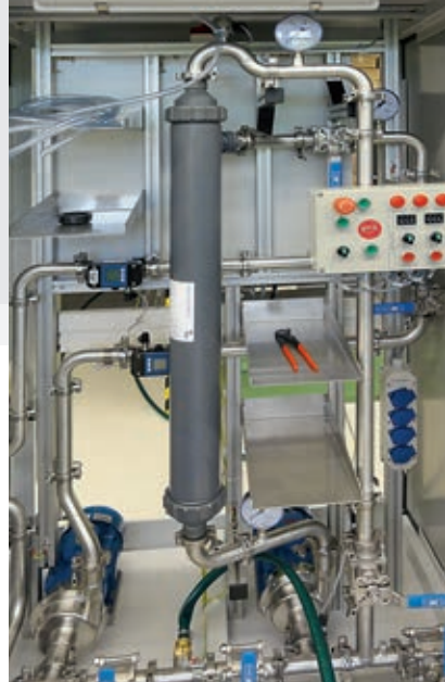
Anlage zur kontinuierlichen Cross-Flow-Ultrafiltration für Wasserproben bis zu mehreren tausend Litern
