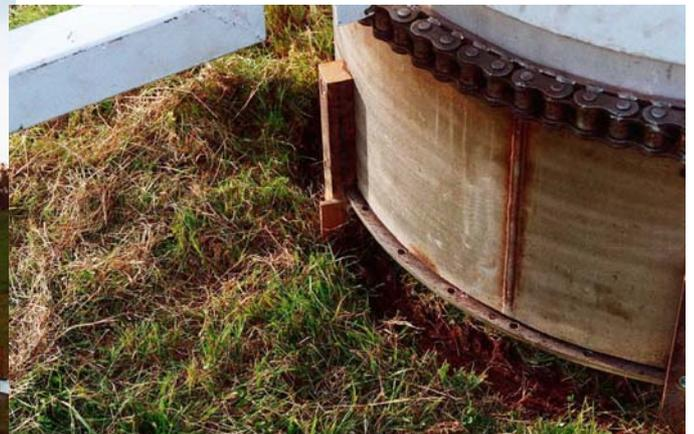
Abb. A 3.1 c Bohrkronen der Fräsvorrichtung
