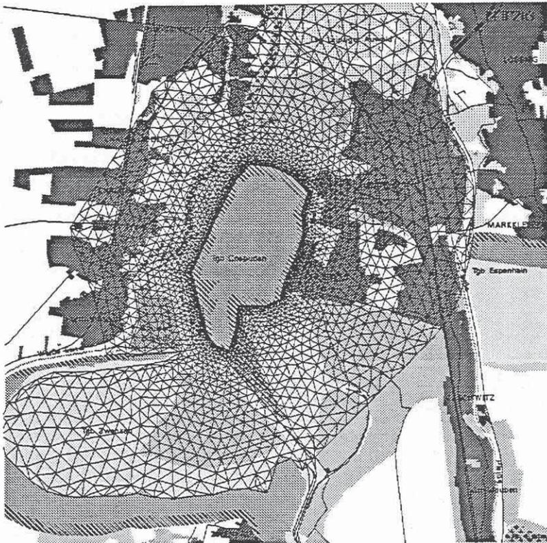
Abb.11: Finites Elementenetz für die Flutungssimulation
